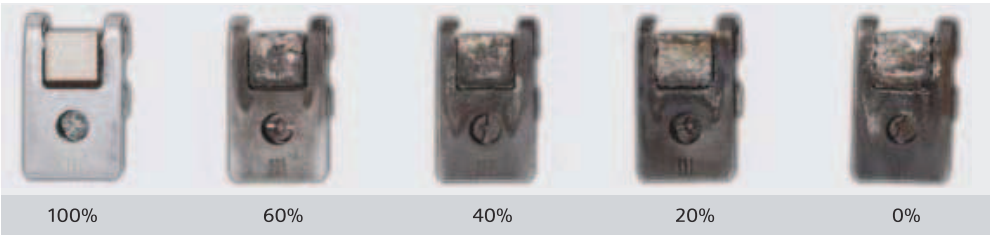
FOTO 5.2 DESGASTE DE LOS CONTACTORES
